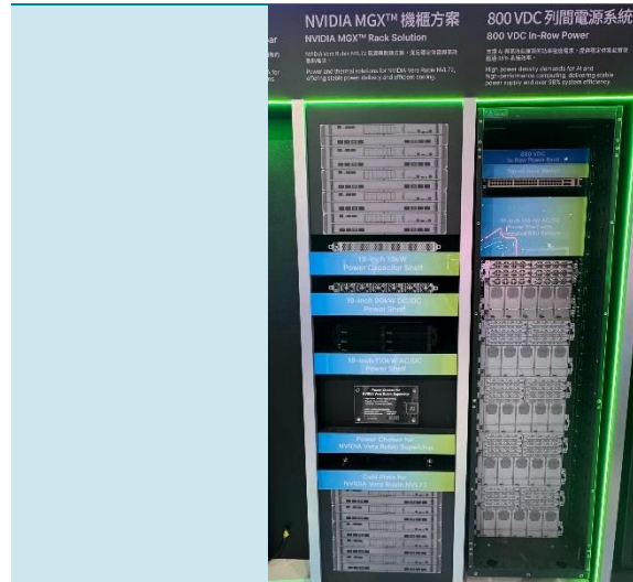
圖表 5：台達電 800 VDC 列間電源系統
